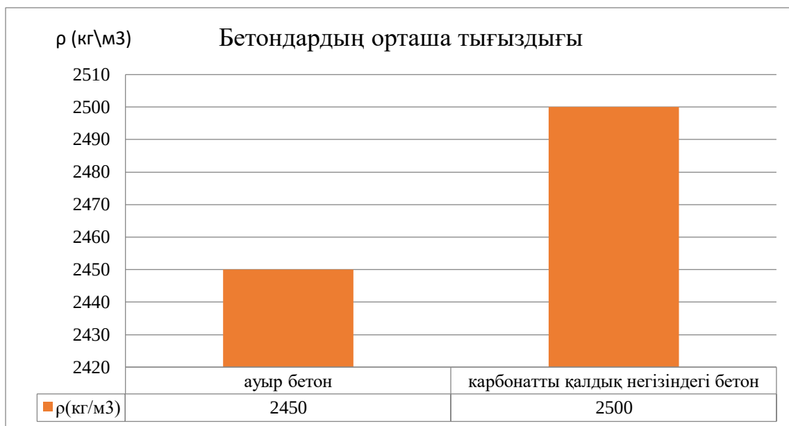
3.6 Сурет – Састөбе карбонатты жыныстарын майдалау кезінде түзілген кондициялы емес қалдықтар негізіндегі толтырғыштармен бетонның тығыздығы
