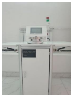
Сурет 4.4.1- HD-w810 Текстиль материалдарының ауа өткізгіштігін өлшеуге арналған құрал
