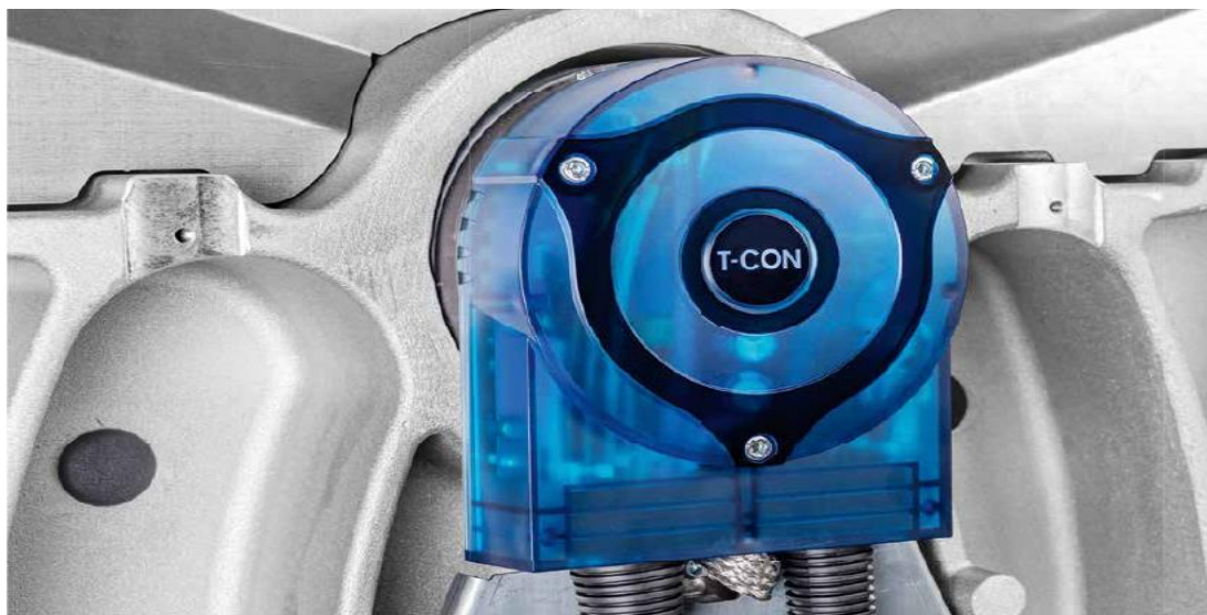
1 сурет - Trutzschler (Германия) фирмасының ТС-15 тарау машинасында орнатылған Т-Con құрылғысы.
