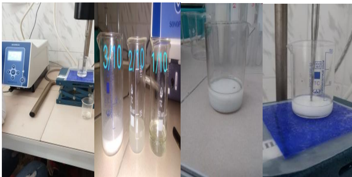
Сурет 2 - Ультрадыбысты гомогенизатор Bandelin SONOPULS HD 4100 арқылы эмульсиялар алу
