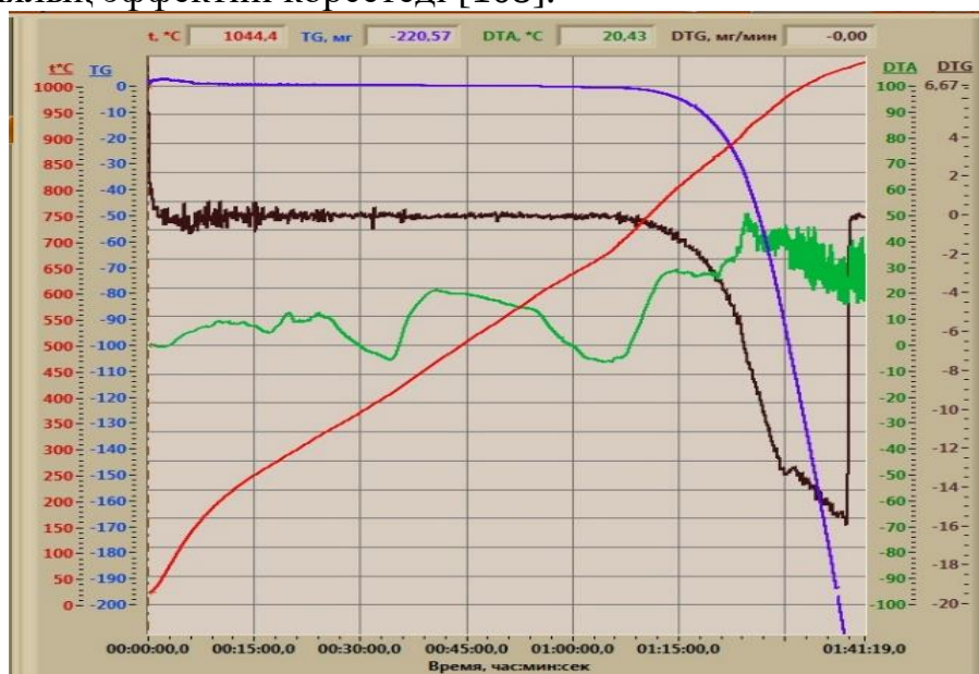
Сурет 4.4– Сатимола кен орнының калий минералының дифференциалды-термиялық талдауы
