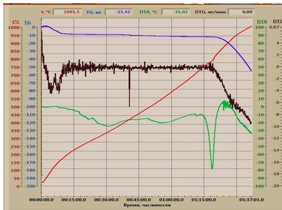
Сурет 3.5 - Бахыт-таңыкен орнындағы табиғи натрий тұзының дифференциалды-термиялық талдауы
