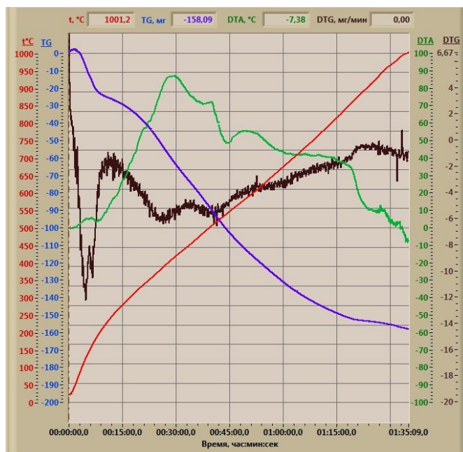
Сурет 3.19 - Тукоқоспа үлгілерінің (Б) термогравиметриялық зерттеулері
