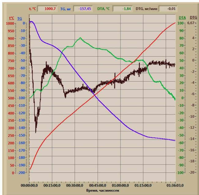
Сурет 3.20 - Тукоқоспа үлгілерінің (В) термогравиметриялық зерттеулері
