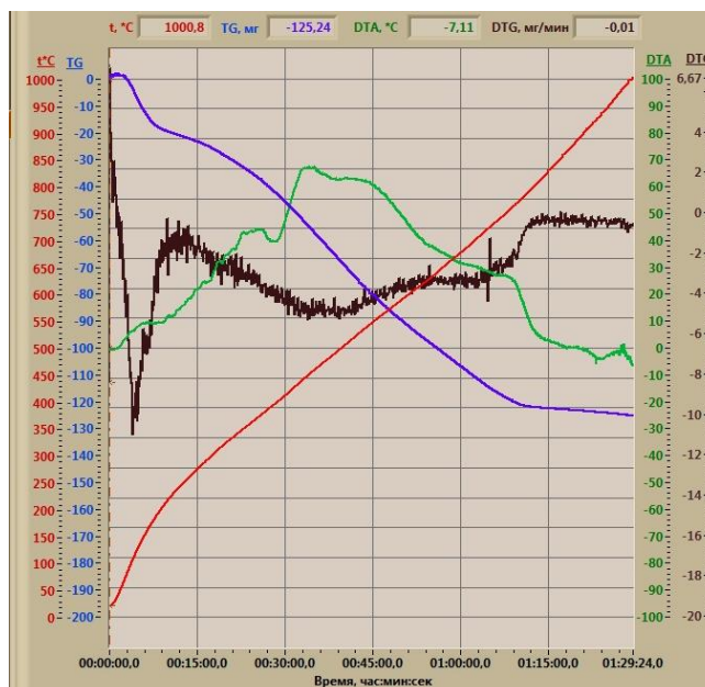
Сурет 3.18 - Тукоқоспа үлгілерінің (А) термогравиметриялық зерттеулері
