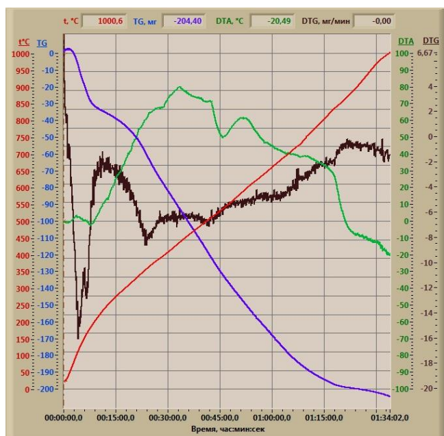
Сурет 3.22 - Тукоқоспа үлгілерінің (Д) термогравиметриялық зерттеулері
