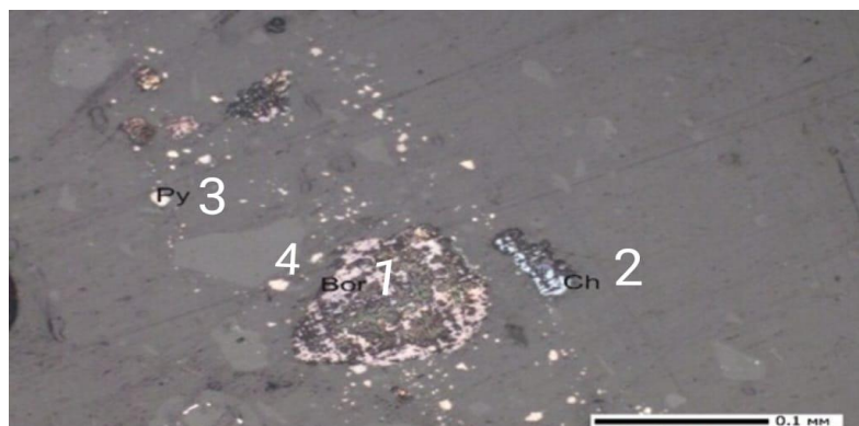
Сурет 2.3 - Кен минералдары: 1-борнит; 2-халкозин; 3-фосфориттегі пирит; 4-темір гидроксиді.
