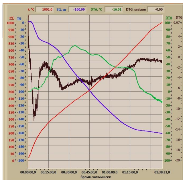
Сурет 3.21 - Тукоқоспа үлгілерінің (Г) термогравиметриялық зерттеулері
