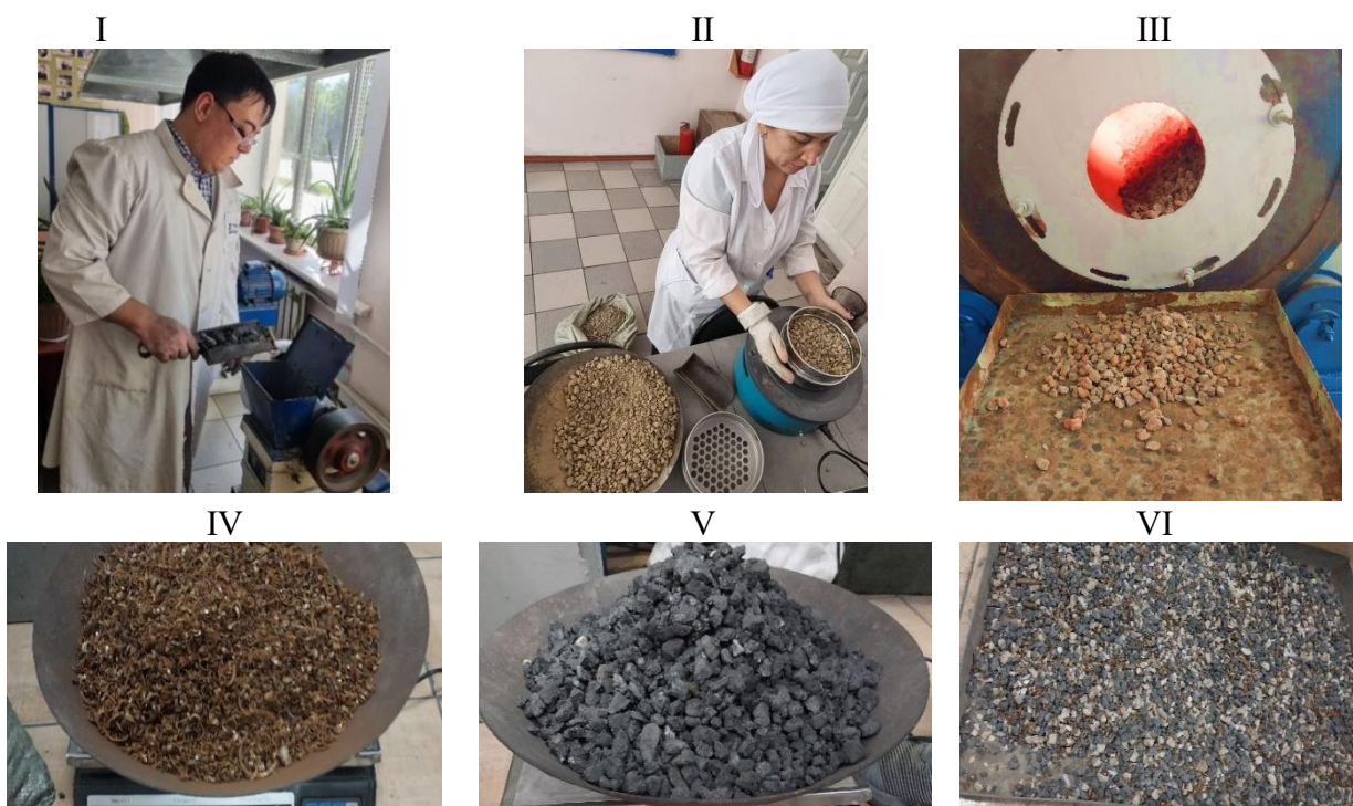
I - дробление сырья, II – рассев сырья, III - декарбонизация фосфорита в барабанной печи, IV – обрезанная стружка, V – дробленный кокс, VI – шихта Рисунок 83 - Фотографии фрагментов подготовительных операций и сырья
