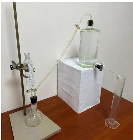
Рисунок 15 - Установка для определения литража карбида кальция
