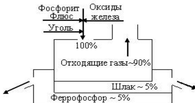
Рисунок 9 - Схема распределения фосфора между продуктами переработки фосфоритов в реакторе РОМЕЛТ
