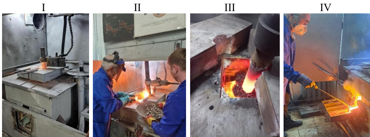
I-розжиг печи, II- загрузка шихты в печи, III-плавка шихты, II-IV -слив расплава
