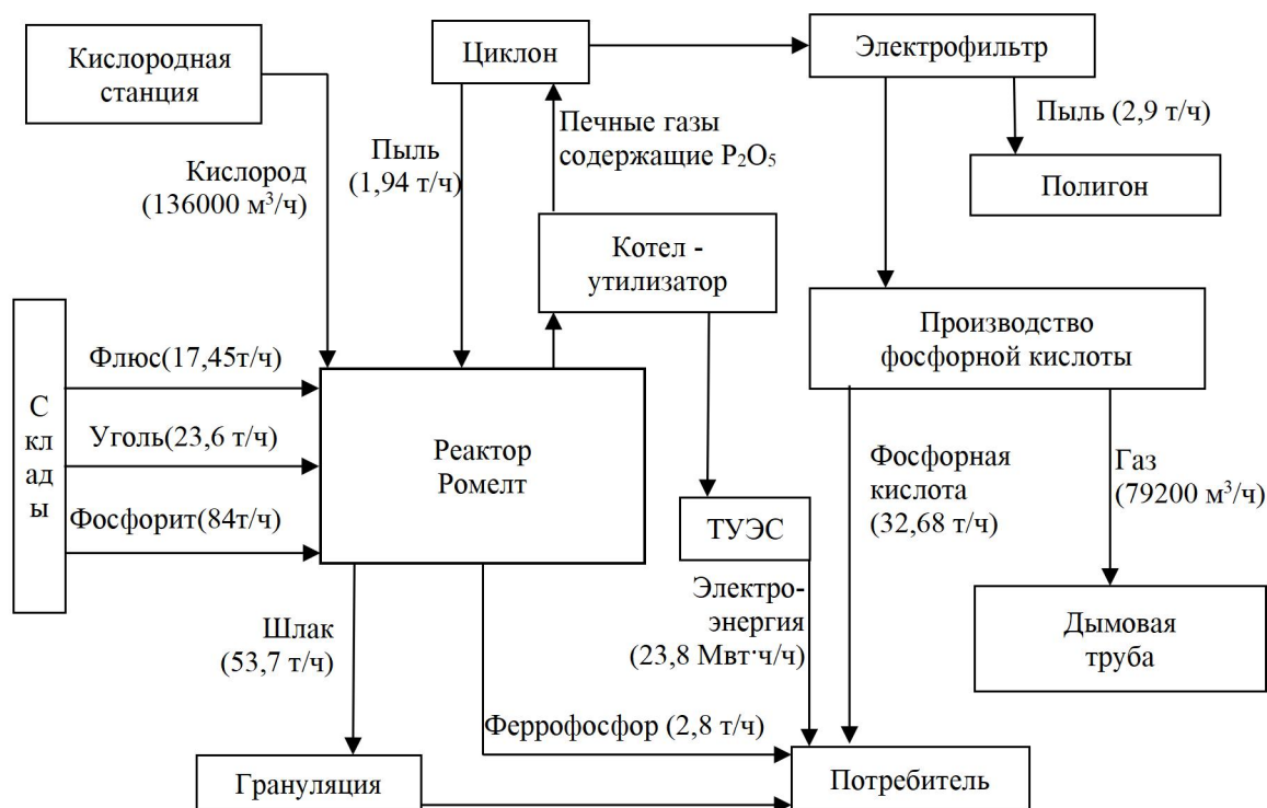
Рисунок 10 - Схема переработки фосфоритов в реакторе РОМЕЛТ
