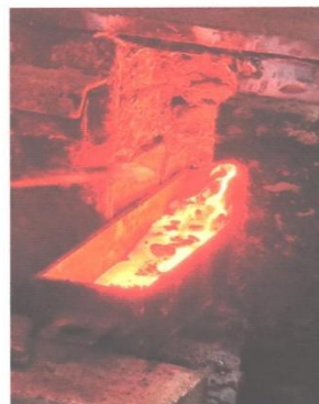
I-рассев руды, II- декарбонизация фосфорита в барабанной печи, III- розжиг печи, IV – загрузка печи шихтой, V- плавка шихты, VI- слив расплава (карбида и ферросплава в изложнице) Рисунок 1- Фрагменты подготовительных операций и электроплавки фосфоритов
