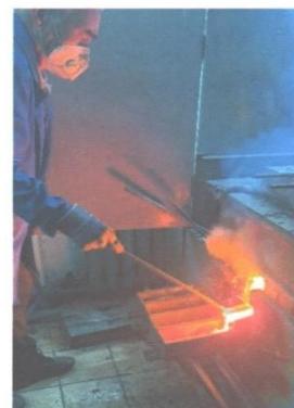
I-рассев фосфорита, II- декарбонизация фосфорита в барабанной печи, III-розжиг печи, IV -загрузка шихты в печи, V- плавка шихты, VI - слив расплава
