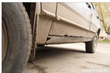
Сурет -1 Жеңіл автокөлік қаңқасының химиялық коррозияға ұшырауы
