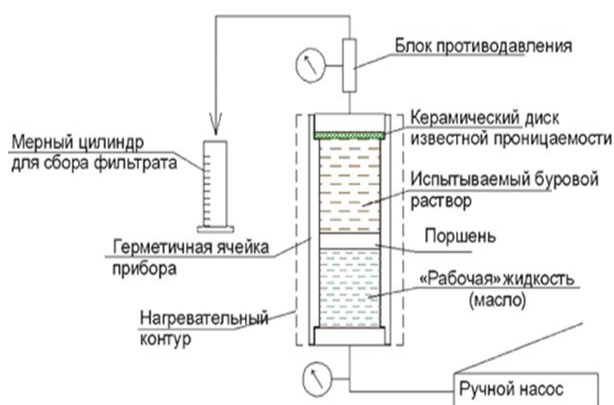
Рисунок 1.2 - Установка по определению кольматации керна [1].
