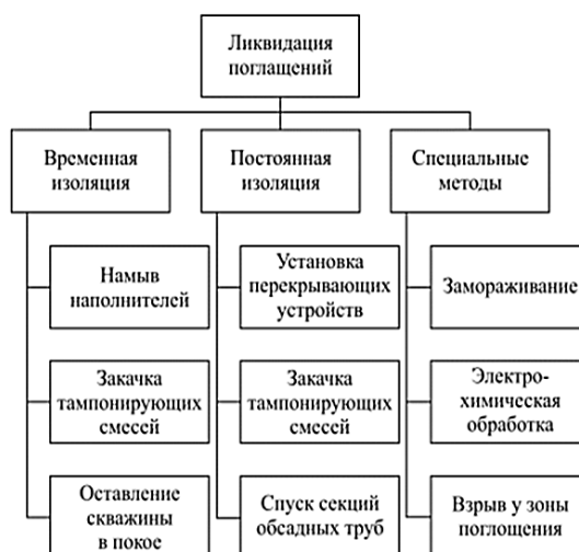
Рисунок 1.1 – Способы, применяемые при ликвидации поглощений БР
