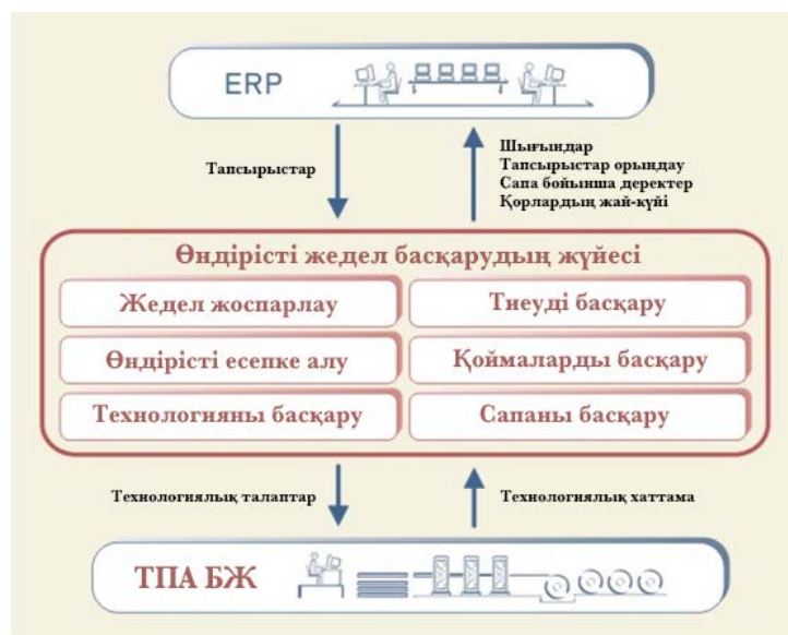
2-сурет. MES жүйесінің кәсіпорынды басқарудың басқа да деңгейлерімен өзара әрекеттестігі.
