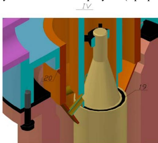
Рисунок 3. Технически рисунок внутреннего распределителя жидкости и газа (в разрезе)
