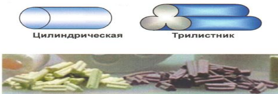
Рисунок 3.4 - Биметаллический катализатор UOP Rexel
