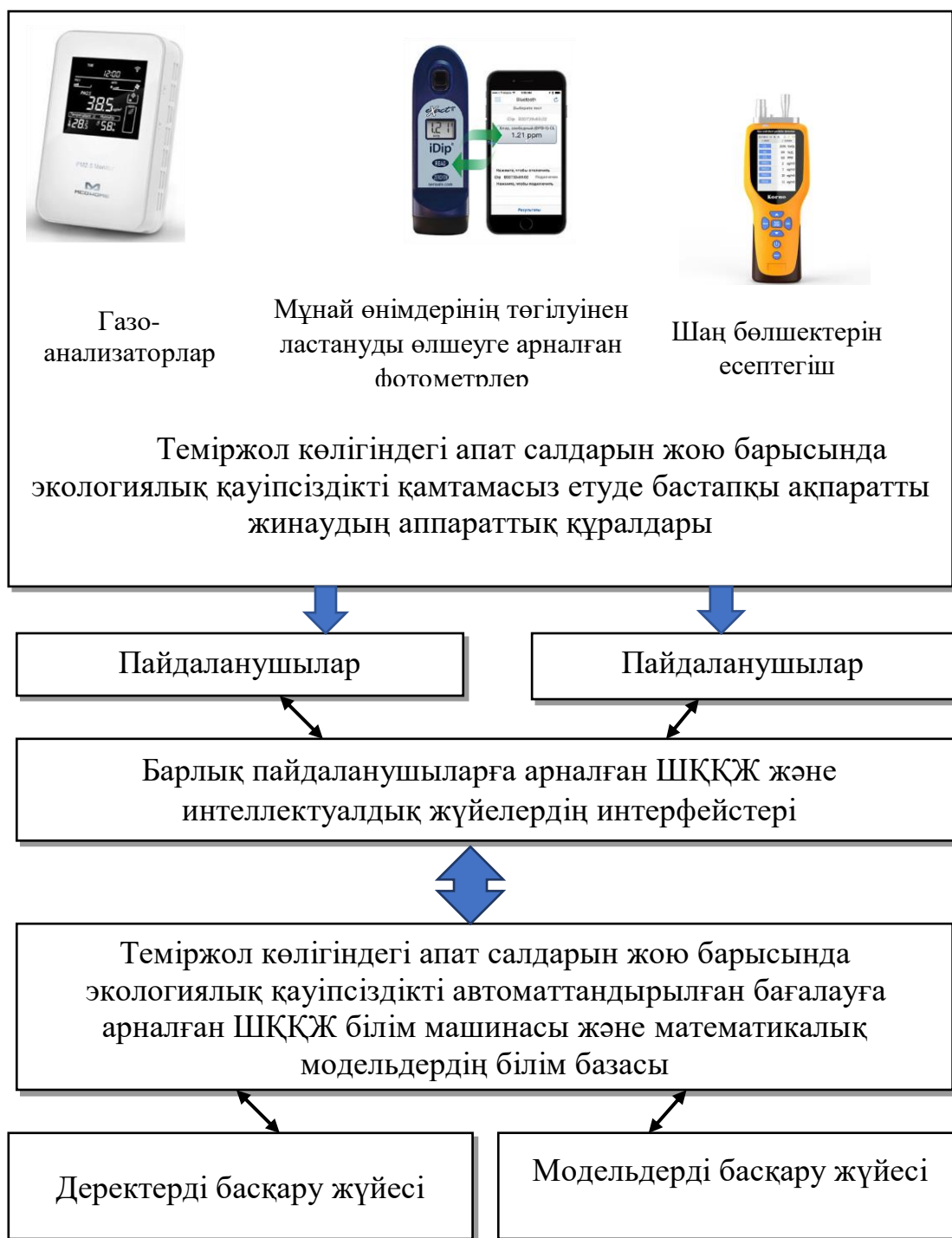
Сурет 1.12 – Теміржол көлігіндегі апат салдарын жою барысында экологиялық қауіпсіздікті автоматтандырылған бағалау модульдері бар ШҚҚЖ базалық архитектурасы [32]
