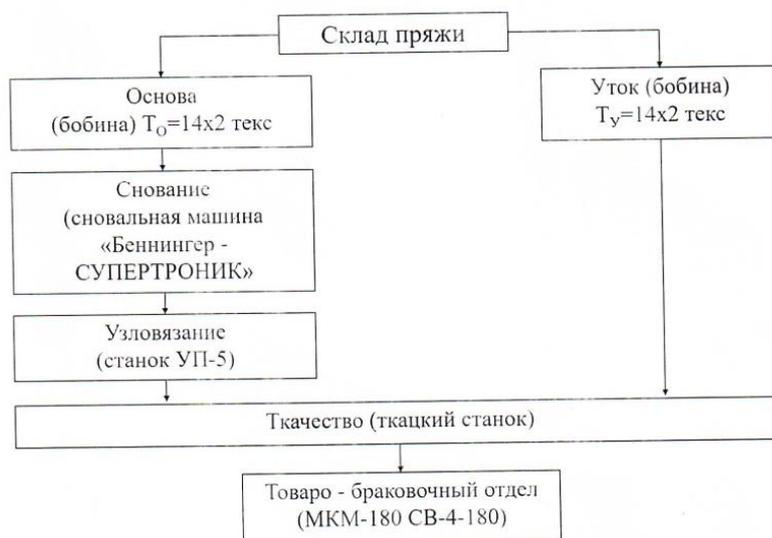
Рисунок 1. Технологический процесс производства сорочечной ткани
