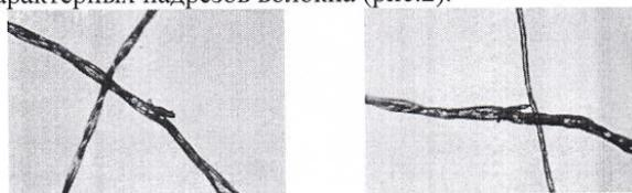
Рисунок 2. Характерные надразы волокон при джидинировании пыльными дисками, обработанными в песочной ванне, x100.
