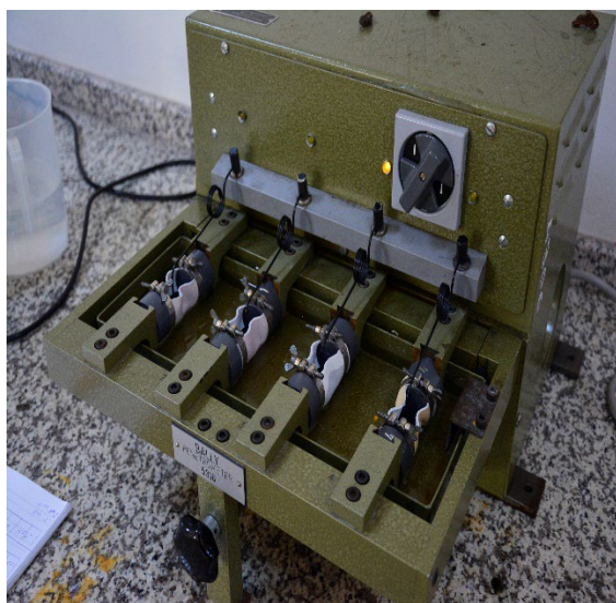
Сурет 2.2- Bally 5316 пенетрометрінде сынақ жұмысы
