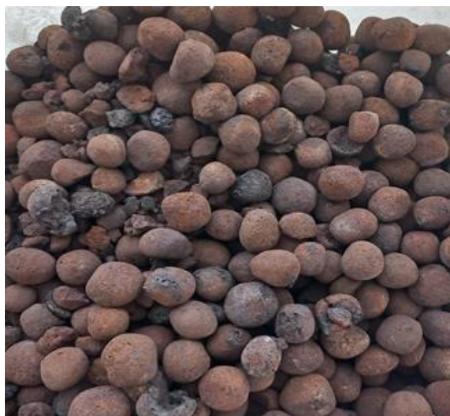
Рисунок 5.10- Гранулы на основе свинцового шлака и дистиллерной жидкости после обжига
