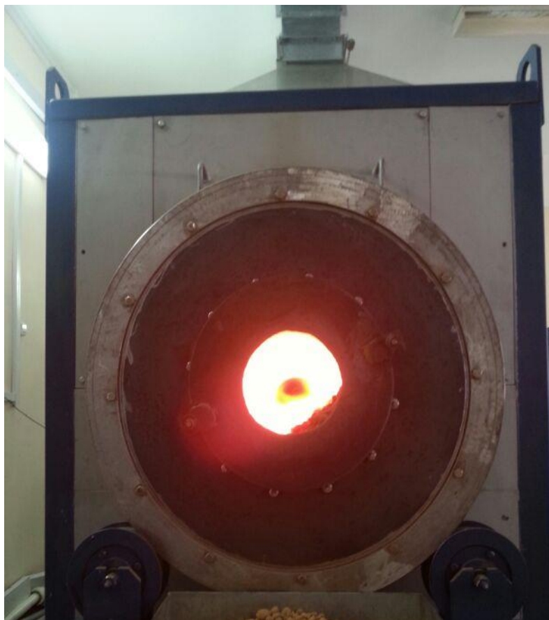
Рисунок 5.9 - Процесс обжига гранул во вращающейся печи
