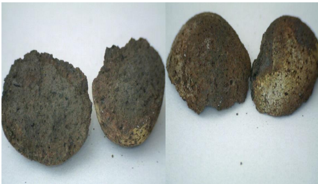
Рисунок 5.11- Фотография внешнего вида и разрезов обожжённых гранул
