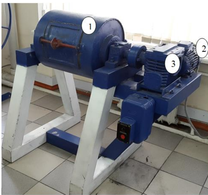
1-барaban, 2- двигатель, 3-редуктор
