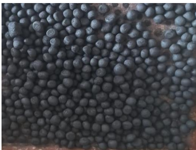
Рисунок 5.3 – Сырые гранулы на основе свинцового шлака и дистиллерной жидкости
