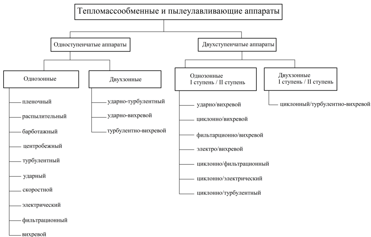
Рисунок 1.1 - Классификация тепломассообменных и пылеулавливающих аппаратов
