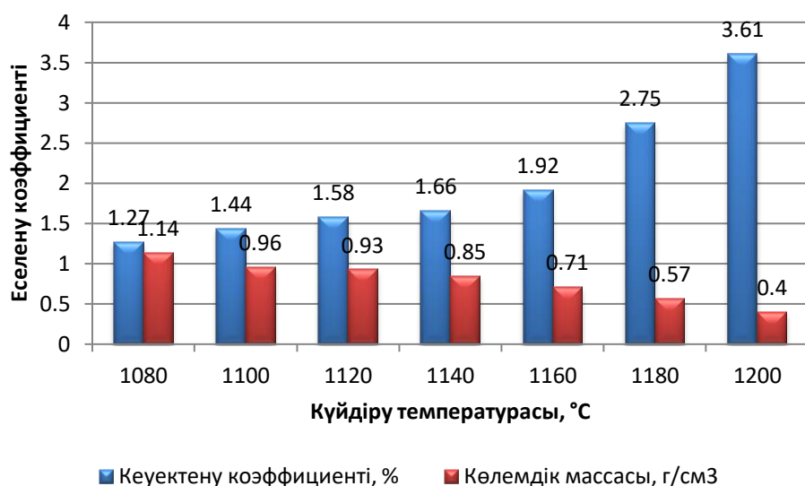
Сурет 26 - Қыңғырақ-Келес бентонит саздары мен мазут қоспасы негізінде алынған керамогрануляттардың кеуектену коэффициентінің және көлемдік массасының өзгеруі
