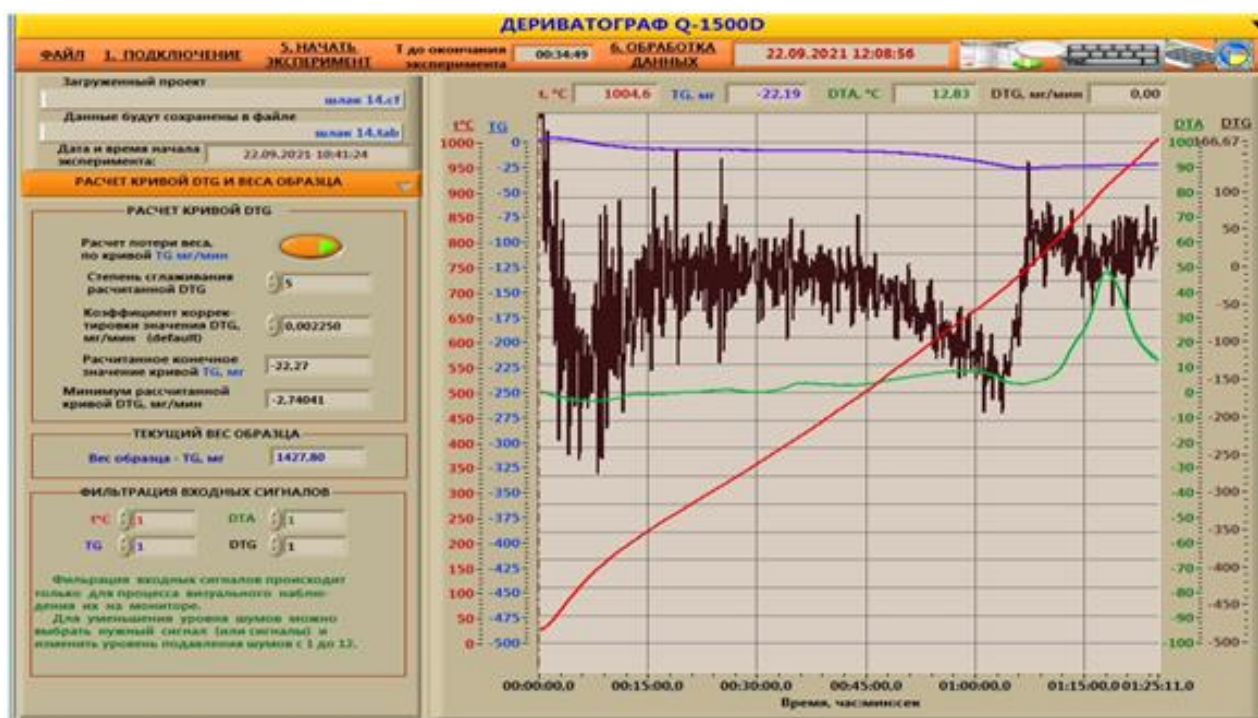
Сурет 22 - Қорғасын өндірісі шлагының термограммасы
