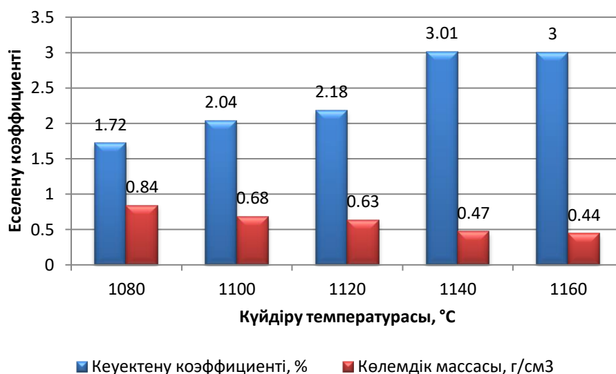
Сурет 24 - Қыңғырақ-Келес бентонит саздары мен органика-минералды қоспа негізінде алынған керамогрануляттардың кеуектену коэффициентінің және көлемдік массасының өзгеруі
