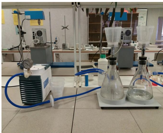
1 – колба Бунзена; 2 – вакуум метр; 3,6 – кран; 4 – Бюхнер үренкесі; 5 – буфер сыйымдылығы Сурет 2.14 – Сүзу қондырғысының схемасы
