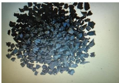
Рисунок 2 - Общий вид резиновой крошки ТОО «Эко-Шина» размером 2-4 мм
