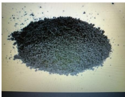
Рисунок 3- Резиновая крошка, выпускаемая на ТОО «Эко-Шина» размером 1-2 мм
