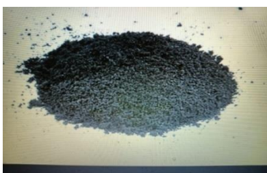
Сурет 3 - «Эко-Шина» ЖШС өндірілетін өлшемі 1-2 мм резина ұнтағының жалпы түрі
