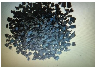
Сурет 2 - «Эко-Шина» ЖШС өлшемі 2-4 мм резина ұнтағының жалпы түрі
