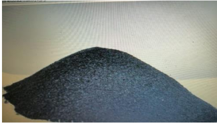
Сурет 4 - «Эко-Шина» ЖШС дисперстілігі 0-1 мм резина ұнтағының жалпы түрі
