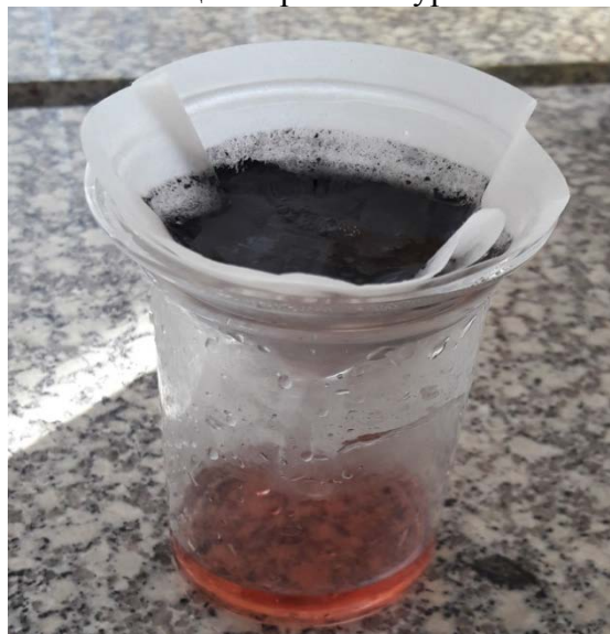
Сурет 2. Ерітіндіден бөлініп алынған графит пен мырыш, марганец тұзының көрінісі
