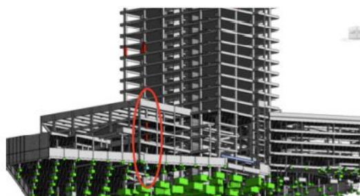
Рис. 2. Линия несоответствующих колонн над несоответствующим фундаментом
