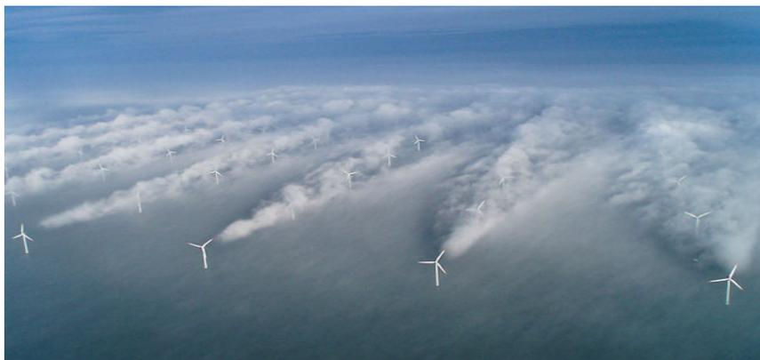
5-сурет. Пропеллер типті жел электр қондырғыларының артындағы турбуленттік құйын [4]
