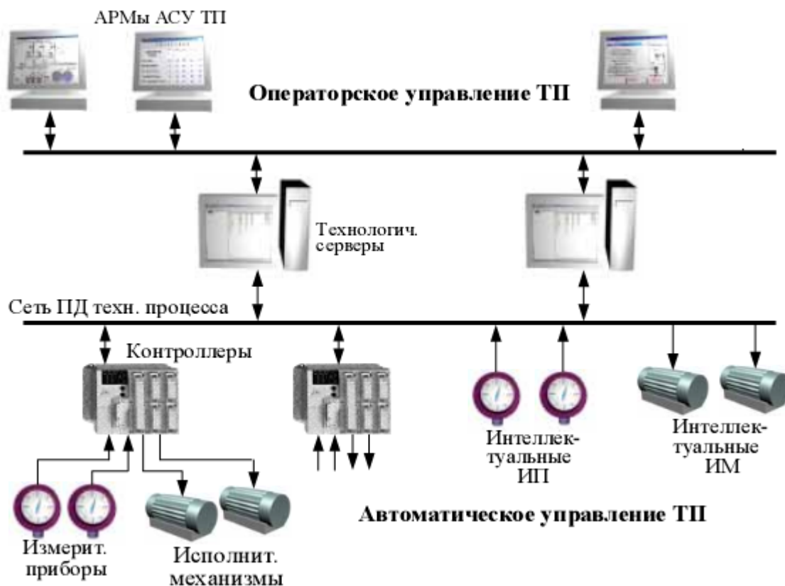
Рис. 2. Функциональная схема двухуровневой структуры управления
