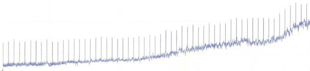
Рис. 4 – Рентгенограмма полученной стекломассы из разработанной шихты в составе кварцевый песок Гурунч-Булакского месторождения, термообработанных при 1450°С
