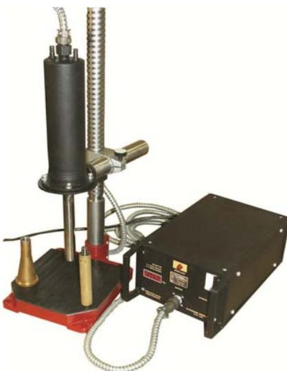
Рисунок 10 – Ультразвуковой генератор
