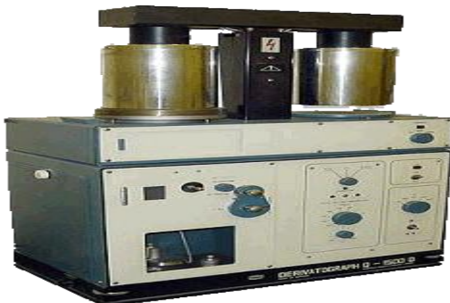
Сурет 2.4 – МЭМ фирмасының дериватографы
