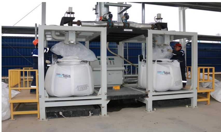
Сурет 2 - «CASPI BITUM «БК» ЖШС-де (Ақтау қ.) балқытылған битумды полимер қапшыққа буып-түю бойынша орнату
