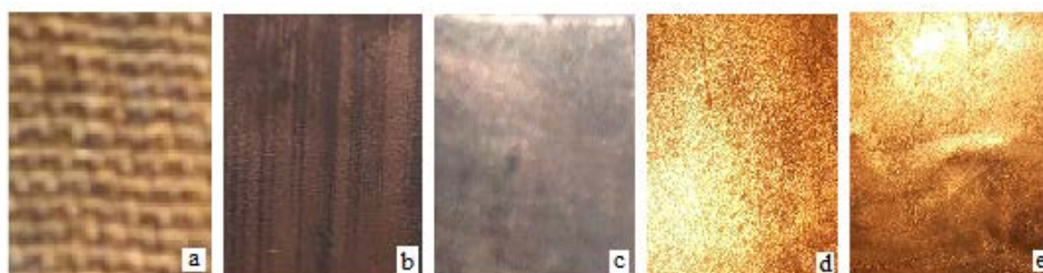
5-сурет. Мыс қабықшамен қапталған диэлектрлі материалдар: а – мақта-мата үлгісі, б – ПВХ материалы, с – пластмасса үлгісі, d – шыны үлгі, е – керамика үлгі
