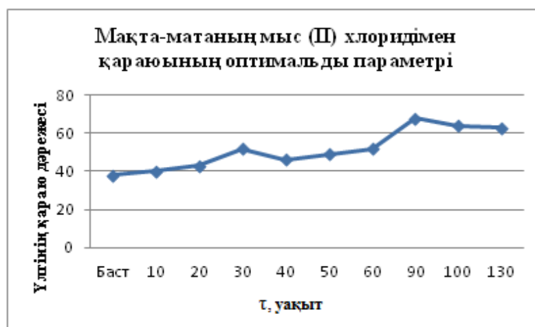
2-сурет. Мақта-мата үлгілерін мыс (II) хлоридімен өңделіп, күн сәулесінің әсерінен қараюына уақыттың әсерінің динамикасы.
