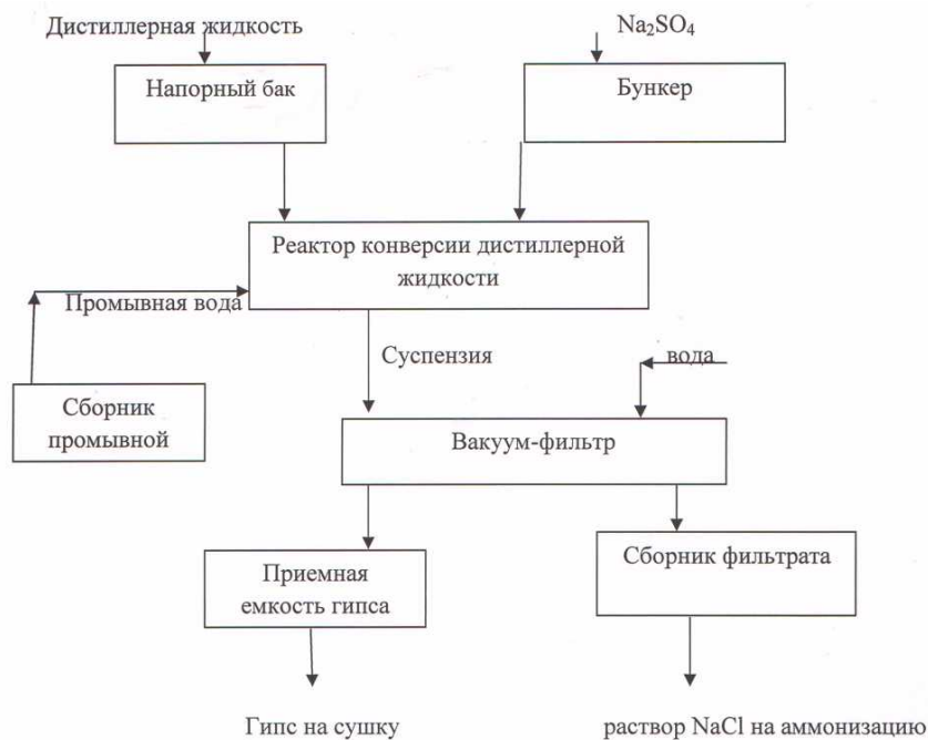
Рис. 1. Принципиальная схема конверсии дистиллерной жидкости
