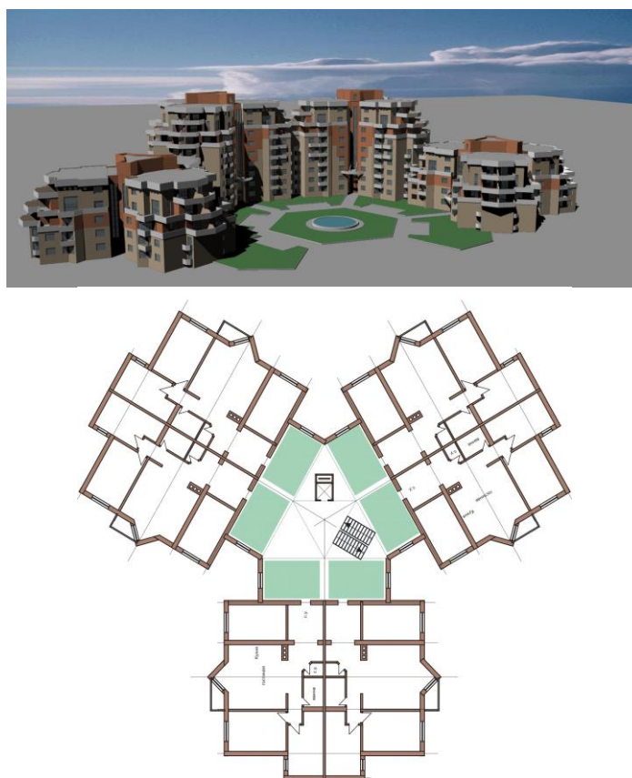
Рис. 2 - Жители попадет в квартиру через собственный летний дворик не заслоняет жилые комнаты и кухню от прямых солнечных лучей. Блокировка летних помещений лестничной клетки позволяет принять дифференцируемую систему отопления. Трансформация стены летней помещений позволяет создать дворик и квартиру для большой семьи.
