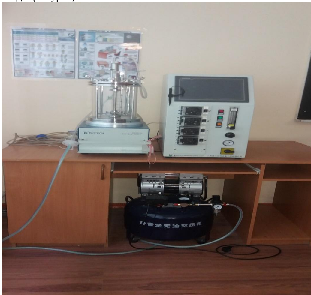
Сурет 5 – Ферментативті гидролиз процестерін зерттеуге арналған қондырғының жалпы түрі
