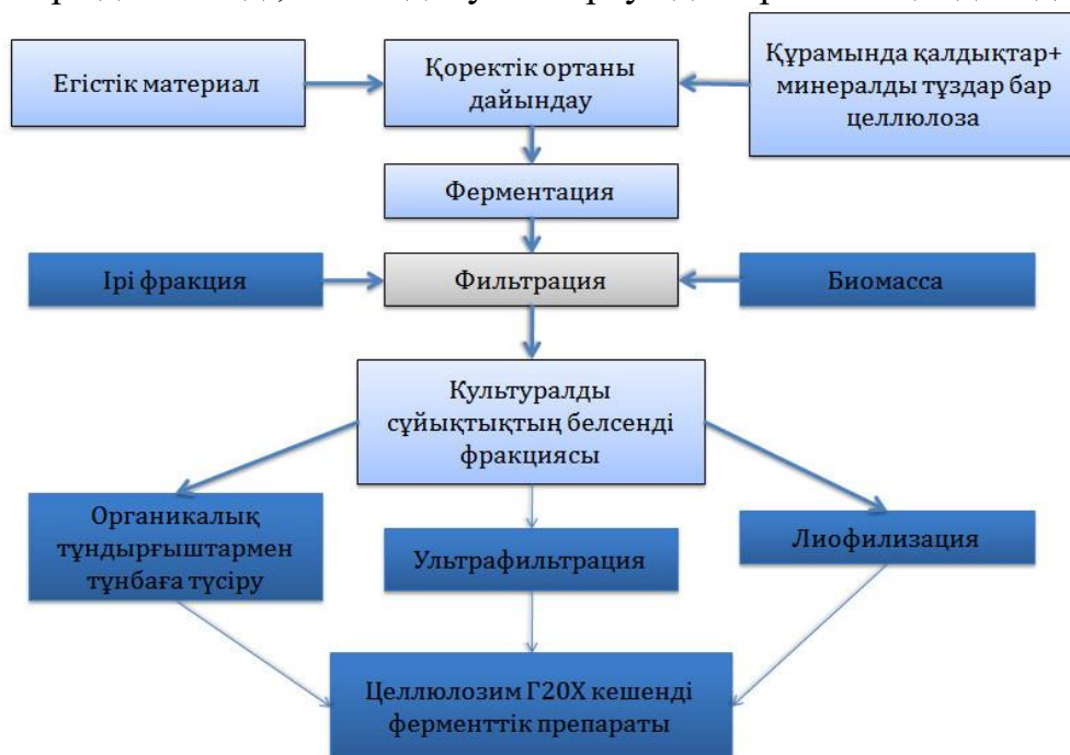
Сурет 23 – «Целлозим Г20х» (микроорганизмдер консорциумы) кешенді ферменттік препаратын алудың технологиялық сызбасы
