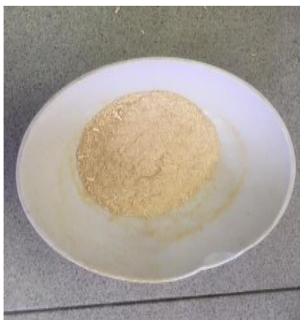
Сурет 26 – ВЦС-50 дірілден орталық тепкіш типті аппаратта бидай сабанын бастапқы механикалық белсендіру
