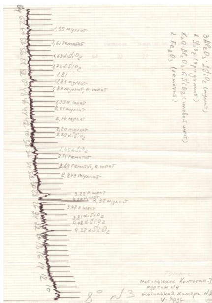
1.3 сурет. №3 үлгі-археологиялық керамикалық хумның рентгенограммасы «Neophot-21» микроскобында жасалған эксперименттер
