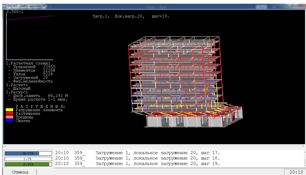
Рис.3б – Состояние рамы с колоннами 50х50см, соответствующее 20-ому этапу загрузки горизонтальной нагрузкой в момент разрушения
